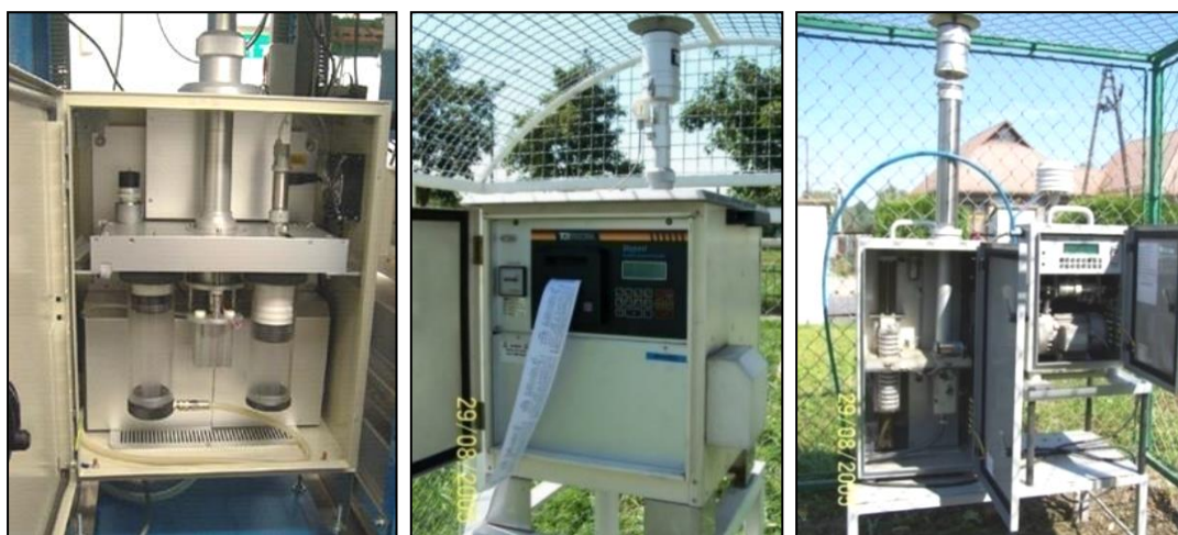
Figura 3 - Postazione di campionamento gravimetrico sequenziale delle polveri
